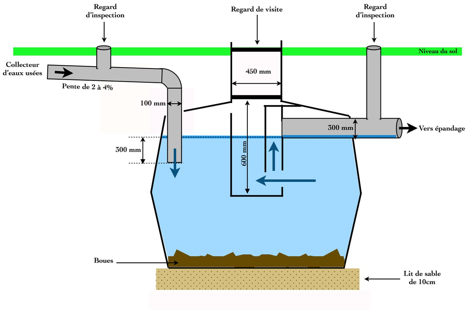
La tuyauterie de raccordement doit être d'au moins 100 mm et de préférence du diamètre de raccordement de la fosse. La pente doit être comprise entre 2 et 4%. Un regard d'inspection sera installé avant le raccordement à la fosse.
